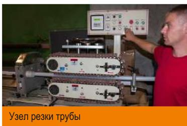
Узел резки трубы
