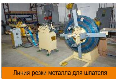
Линия резки металла для шпателя
